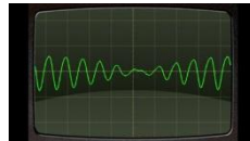
Smartphone 3 als Oszilloskop zur Messung der Schwebung.
